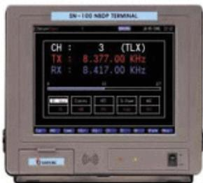
Судовой телексный терминал SN-100 предназначен для подключения к ПВ/КВ радиоустановкам SRG-1150DN и SRG-1250DN при оснащении судна под район плавания A3/A4 ГМССБ.
