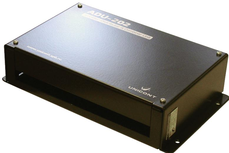
Устройство ADU-202 предназначено для усиления и размножения сигналов NMEA 0183 версий 1 - 3, а также иных сигналов при последовательной передаче данных через интерфейсы RS-232 и RS-422/485. Кроме того, блок ADU-202 имеет интегрированный сумматор, который позволяет комбинировать предложения NMEA 0183, получаемые по входным каналам, и передавать результат на одну или две группы выходов.
